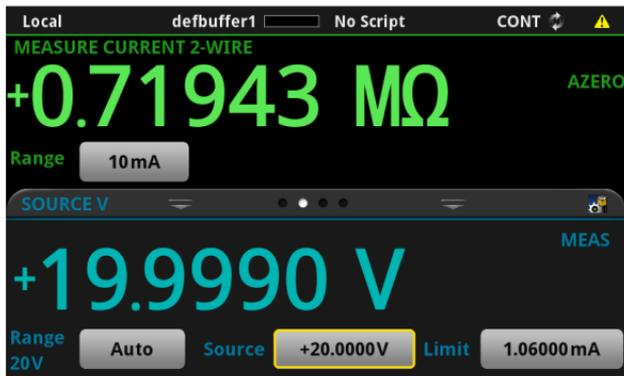
主屏幕最上面一行显示状态和事件指示器。可以选择这些选项来打开对话框，并获得关于状态或事件的更多信息。
