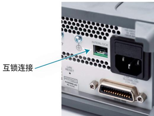
互锁适用于常开型开关的运作，开关可以安装在测试装置的机盖上、半导体探测器或设备搬运机的外壳上，或者安装在测试设备机架的舱门上。在检修门打开时，该电路开路；在检修门关闭时，该电路闭路。
