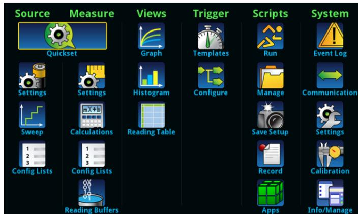
在此屏幕中，可以选择源、测量、绘图、触发器、脚本编制和系统设置菜单。这些菜单允许您选择可按照您的应用要求设置仪器的选项。
