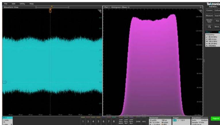
可以将多个绘图添加至测量（不同的测量或同一测量）。例如，可以为同一测量添加两个直方图绘图，然后设置一个绘图显示含对数刻度的 X 轴，而另一个绘图显示含线性刻度的 X 轴。
