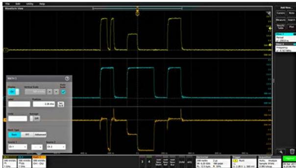
3. 使用配置菜单调整波形参数。所显示的字段将取决于菜单中的波形和选项。选项更改将立即生效。
