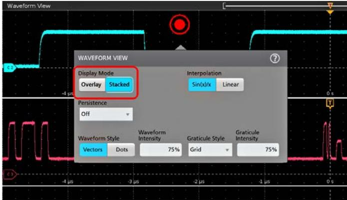
2. 点击 **Display Mode**（显示模式）中的按钮在 **Overlay**（叠加）与 **Stacked**（堆叠）模式之间切换。
