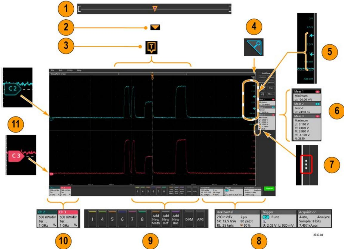
1. Waveform Record View（波形记录视图）为图形化高级视图，包括整个波形记录长度、屏幕上的记录数量（以括号显示）、包括触发事件在内的主要时间事件位置以及当前波形光标位置。
