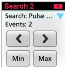
某些搜索还提供 **Min**（最小值）和 **Max**（最大值）导航按钮，可打开缩放模式并将波形在显示中按该搜索事件在当前采集中的最小值或最大值居中。
