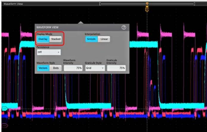
3. 使用其他控件设置波形插补算法、波形点余辉、样式和亮度以及刻度样式和亮度。
