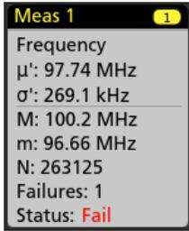
“测量”标记以创建顺序列出，从“结果”栏顶部开始显示。删除“测量”标记不会更改剩余标记的顺序或名称。您可以拖动“测量”标记来更改它们在**结果**栏中的位置，然后打开标记右键点击菜单以访问快速操作菜单。删除 Channel（通道）和 Waveform（波形）标记有两种方法。
