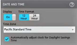
2. 要停止在屏幕上显示日期和时间，请点击 **Display（显示）** 按钮，设为 **Off（关）**。
