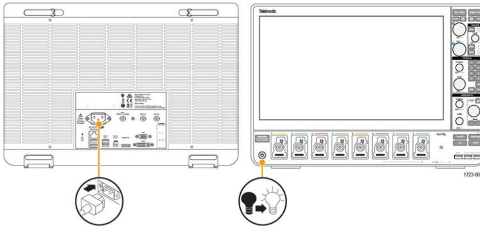
图1: 电源线连接器和电源待机开关
