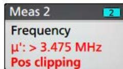
要关闭限幅消息，请更改垂直刻度以显示整个波形，将探头端部与过高电压源断开，并确认您正使用合适的探头探测合适的信号。
