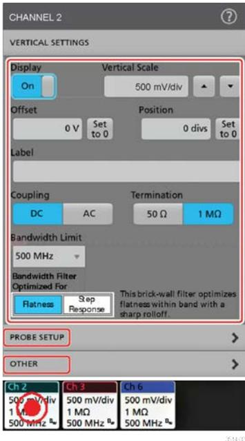
2. 点击 **Probe Setup**（探头设置）面板确认探头设置并运行所支持的探头的配置或补偿。
