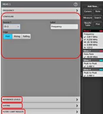
4. 使用可用字段调整测量条件。所显示的字段将取决于测量。选项更改将立即生效。选项更改也还会更改其他面板中的字段。
